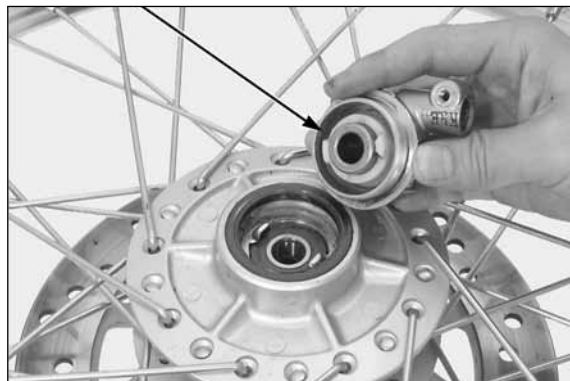
CAIXA DA ENGRENAGEM DO VELOCÍMETRO
