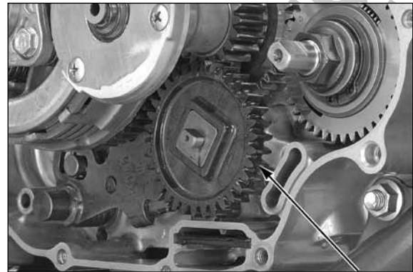
ENGRENAGEM MOTORA
