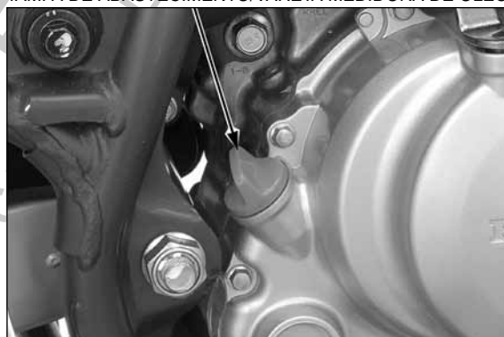
TAMPA DE ABASTECIMENTO/VARETA MEDIDORA DE ÓLEO
