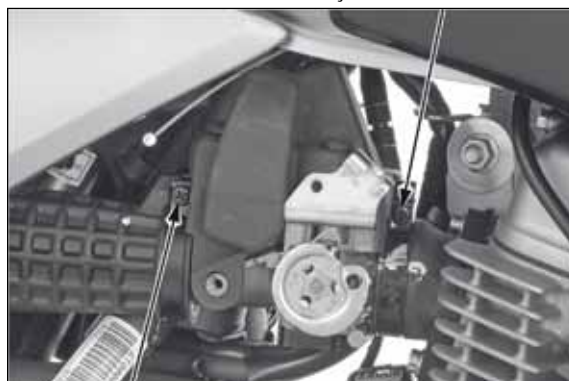
PARAFUSO DA BRAÇADEIRA DA MANGUEIRA DE CONEXÃO PARAFUSO DA BRAÇADEIRA DO ISOLANTE
