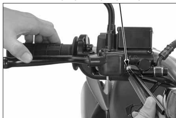
INTERRUPTOR DA LUZ DO FREIO DIANTEIRO
