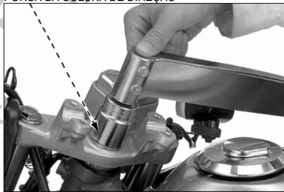
PORCA DA COLUNA DE DIREÇÃO
