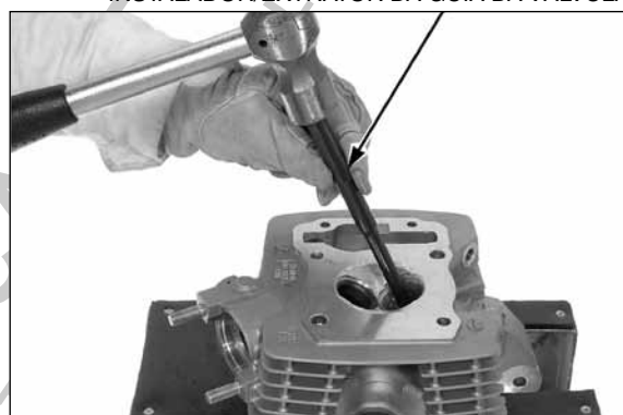
INSTALADOR/EXTRATOR DA GUIA DA VÁLVULA
