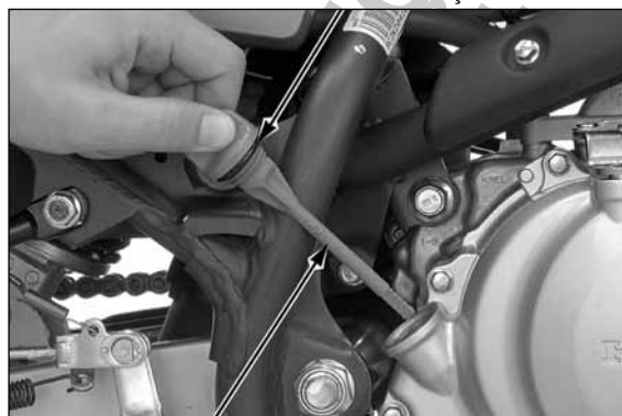
TAMPA DE ABASTECIMENTO/VARETA MEDIDORA DE ÓLEO
