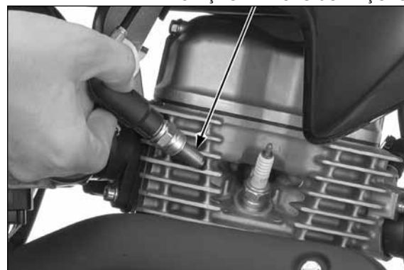
VELA DE IGNIÇÃO EM BOAS CONDIÇÕES
