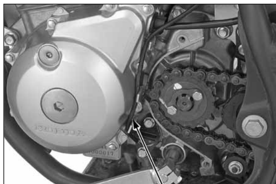
FIAÇÃO DO INTERRUPTOR DE PONTO MORTO
