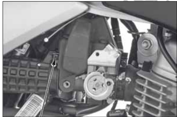
PARAFUSO DA BRAÇADEIRA DA MANGUEIRA DE CONEXÃO
