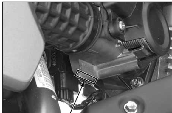
NÚMERO DE IDENTIFICAÇÃO DO CORPO DO ACELERADOR
