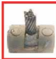
IMAGEM AMPLIADA DO CABO ROMPIDO NA EXTREMIDADE
