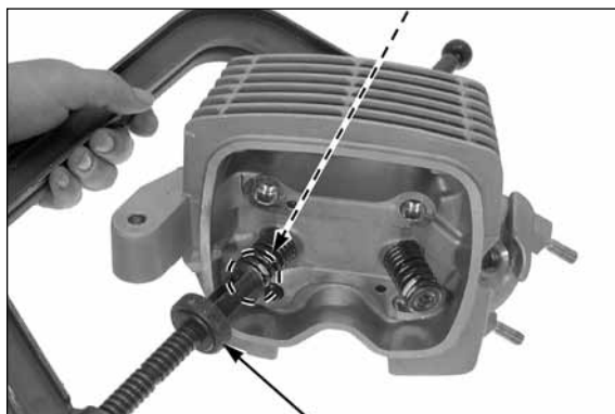
COMPRESSOR DA MOLA DA VÁLVULA
