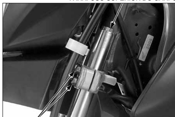
PARAFUSOS DE FIXAÇÃO DA MESA INFERIOR
