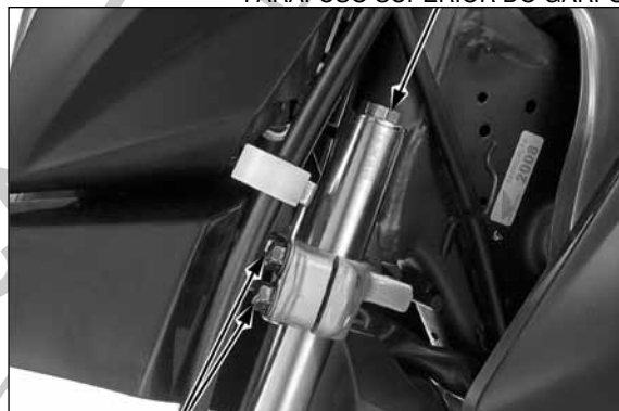
PARAFUSOS DE FIXAÇÃO DA MESA INFERIOR
