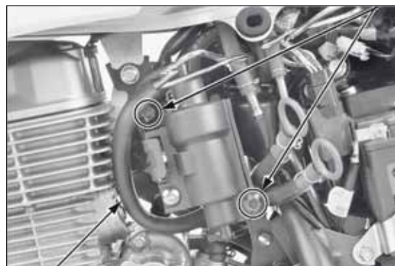
MANGUEIRA DE ALIMENTAÇÃO DE COMBUSTÍVEL (para o injetor)
