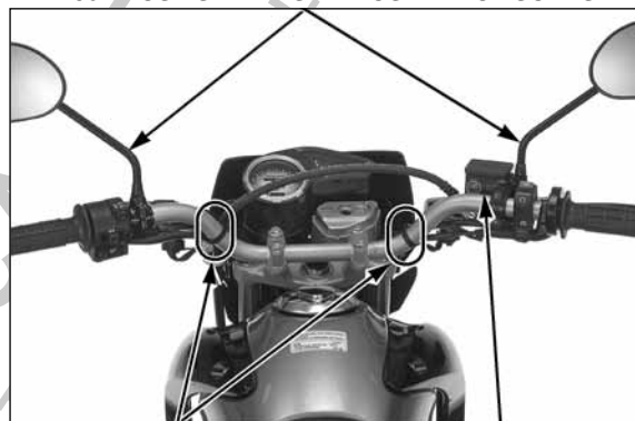
PRESILHAS DA FIAÇÃO CILINDRO MESTRE DO FREIO (NXR150 BROS ESD)
