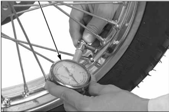
MANÔMETRO DE PNEU
