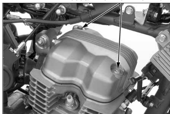
PARAFUSOS/ARRUELAS DE BORRACHA
