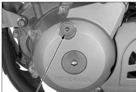
TAMPA DO ORIFÍCIO DO PONTO DE IGNIÇÃO
