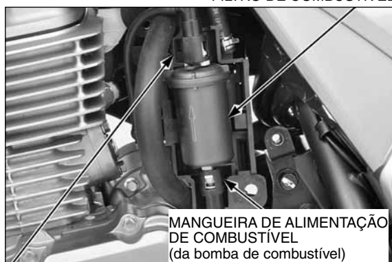
MANGUEIRA DE ALIMENTAÇÃO DE COMBUSTÍVEL (para o regulador de pressão)
