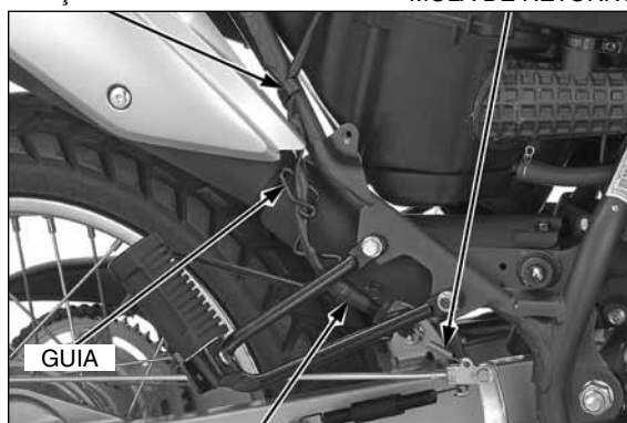
INTERRUPTOR DA LUZ DO FREIO TRASEIRO
