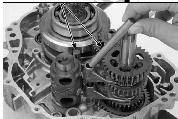
EIXOS DOS GARFOS SELETORES
