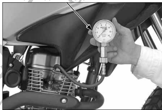
MEDIDOR DE COMPRESSÃO
