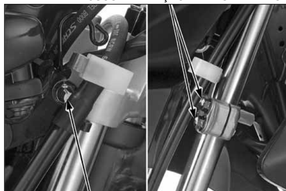
PARAFUSO DE FIXAÇÃO DA MESA SUPERIOR
