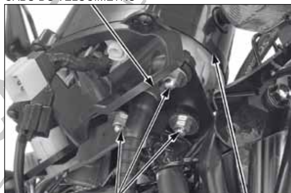
PORCAS/ARRUELAS PAINEL DE INSTRUMENTOS SUPORTE DO PAINEL DE INSTRUMENTOS CONECTORES
