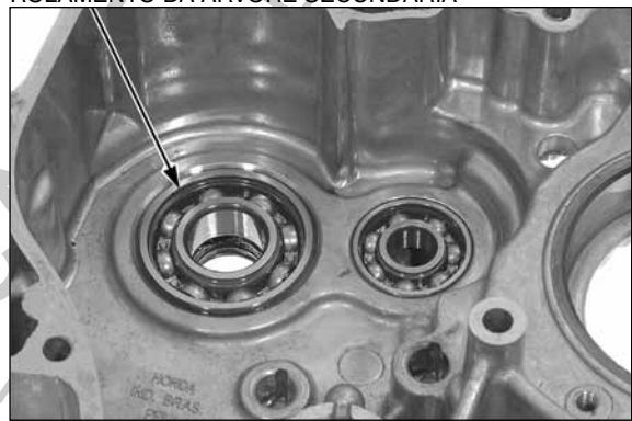
CABEÇA EXTRATORA ROLAMENTO DA ÁRVORE PRIMÁRIA
