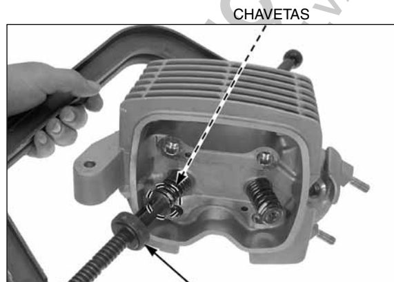
COMPRESSOR DA MOLA DA VÁLVULA
