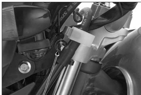
PARAFUSO DE FIXAÇÃO DA MESA SUPERIOR
