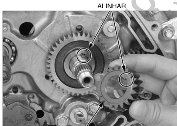
ENGRENAGEM MOTORA PRIMÁRIA
