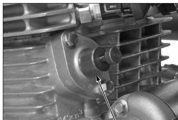
FIXADOR DO TENSOR DA CORRENTE DE COMANDO
