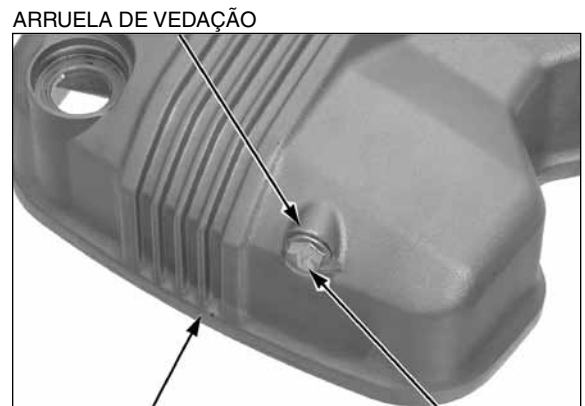
TAMPA DO CABEÇOTE PARAFUSO PASSAGEM DE ÓLEO
