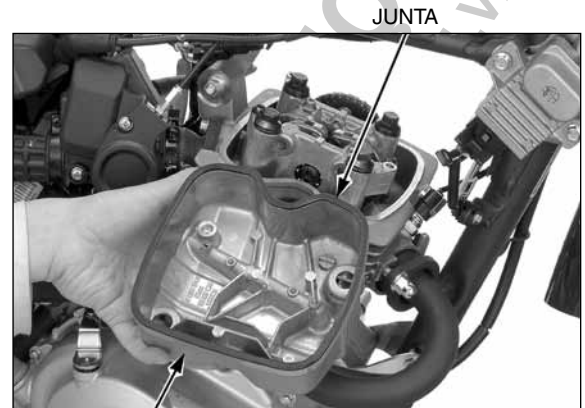
TAMPA DO CABEÇOTE CONDUTO DE ÓLEO
