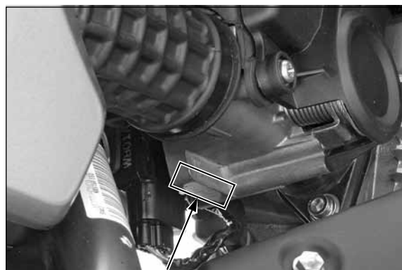
NÚMERO DE IDENTIFICAÇÃO DO CORPO DO ACELERADOR
