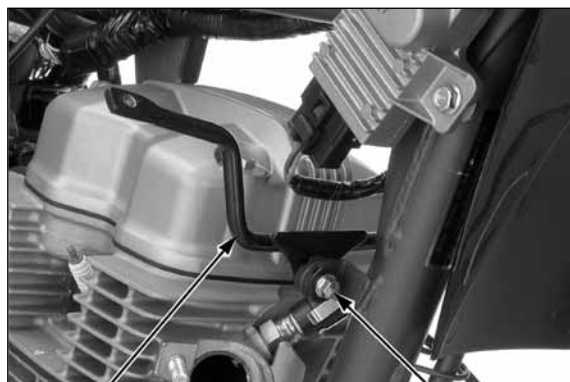
SUPOORTE DO PROTETOR PARAFUSO/BUCHA
