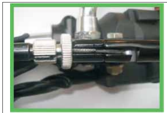
AJUSTADOR E CONTRAPORCA POSICIONADOS INCORRETAMENTE
