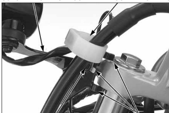
PARAFUSO DE FIXAÇÃO DA MESA SUPERIOR
