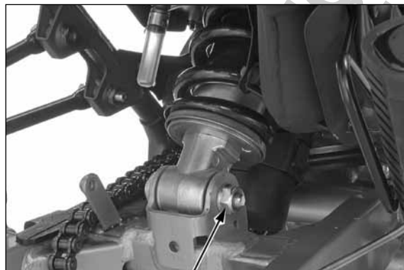
PARAFUSO/PORCA DE MONTAGEM INFERIOR BRAÇO OSCILANTE
