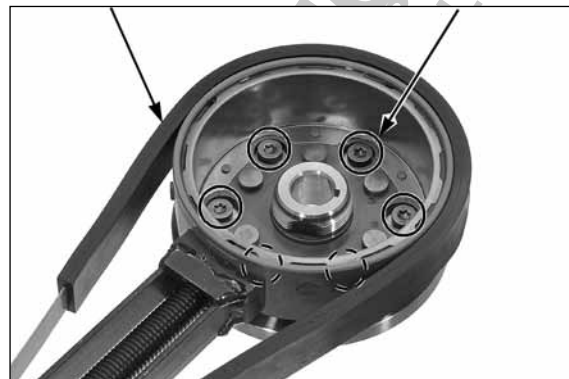
ROTOR DO ALTERNADOR TAMPA DA EMBREAGEM
