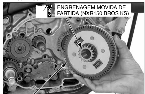
ENGRENAGEM MOVIDA PRIMÁRIA Moto Honda da Amazônia Ltda.
