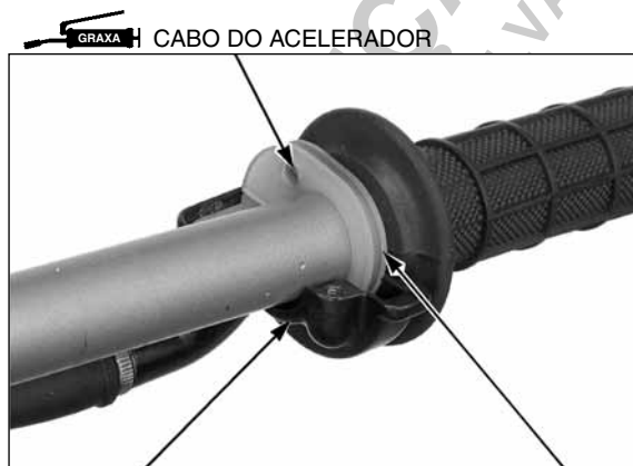
ALOJAMENTO INFERIOR DO ACELERADOR TUBO DO ACELERADOR
