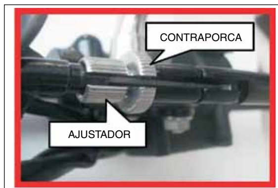
AJUSTADOR E CONTRAPORCA POSICIONADOS INCORRETAMENTE
