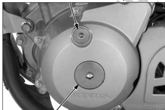
TAMPA DO ORIFÍCIO DA ÁRVORE DE MANIVELAS
