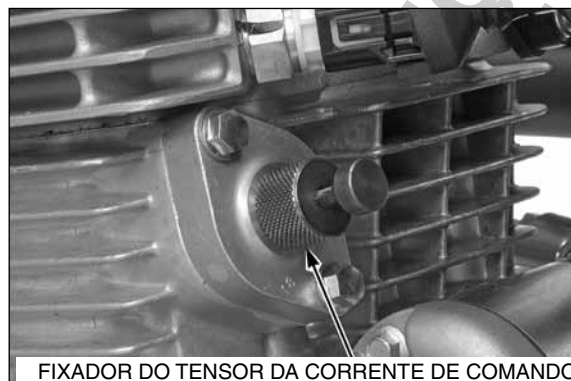
FIXADOR DO TENSOR DA CORRENTE DE COMANDO
