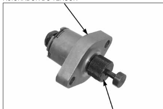
FIXADOR DO TENSOR DA CORRENTE DE COMANDO
