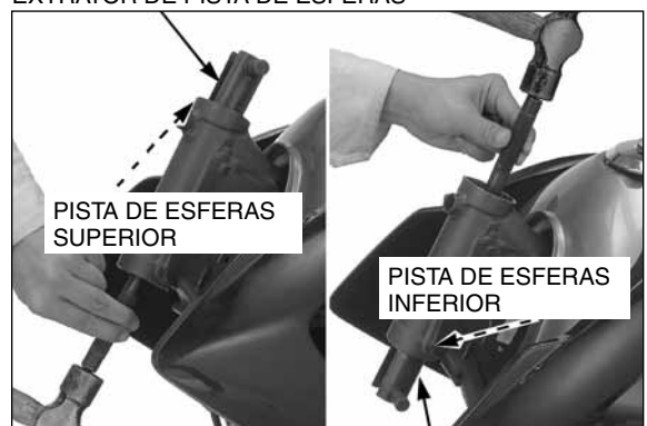
EXTRATOR DE PISTA DE ESFERAS
