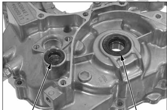
RETENTOR DE PÓ DO EIXO DO SELETOR DE MARCHAS RETENTOR DE PÓ DA ÁRVORE SECUNDÁRIA ROLAMENTO DA ÁRVORE SECUNDÁRIA
