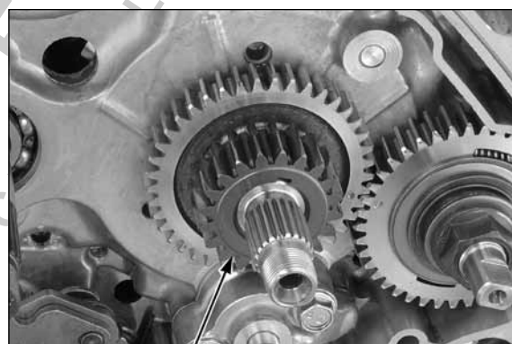
ENGRENAGEM MOTORA PRIMÁRIA
