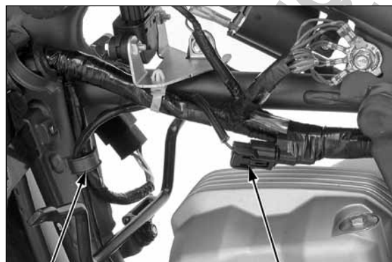
BRACEIRA CONECTOR 1P (PRETO) CONECTOR 2P (PRETO) DO SENSOR EOT
