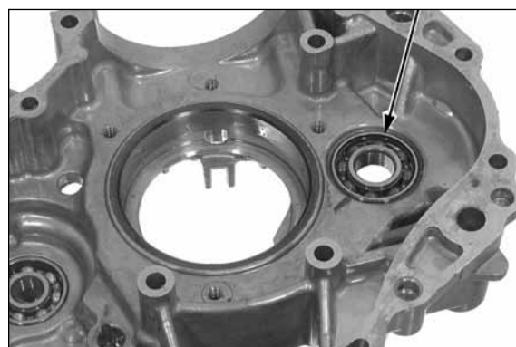
ROLAMENTO DO EIXO DO BALANCEIRO
