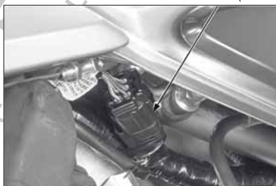
TAMBOR DO ACELERADOR SUPORTE DO CABO CONECTOR 6P (PRETO)
