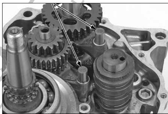
EIXOS DOS GARFOS SELETORES
