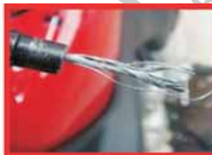
CABO ROMPIDO DEVIDO À MONTAGEM INCORRETA
