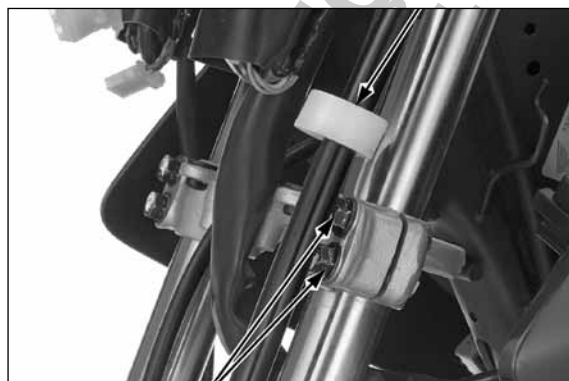
PARAFUSOS DE FIXAÇÃO DA MESA INFERIOR
