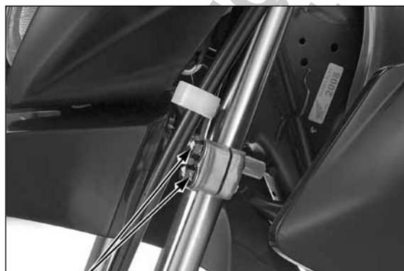
PARAFUSOS DE FIXAÇÃO DA MESA INFERIOR
