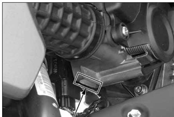
NÚMERO DE IDENTIFICAÇÃO DO CORPO DO ACELERADOR
