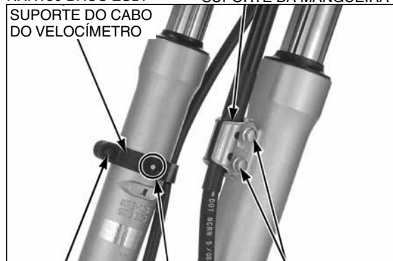
PARAFUSO/PORCA ALINHAR PARAFUSOS SUPORTE DO PAINEL DE INSTRUMENTOS PARAFUSOS
