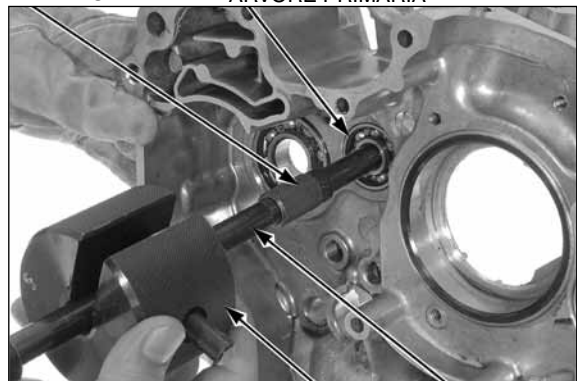
CONTRAPESO EXTRATOR EIXO EXTRATOR
