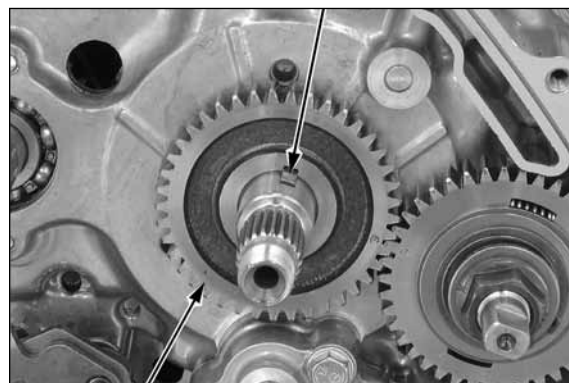
ENGRENAGEM MOTORA DO BALANCEIRO
