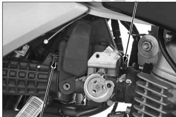
PARAFUSO DA BRAÇADEIRA DA MANGUEIRA DE CONEXÃO
